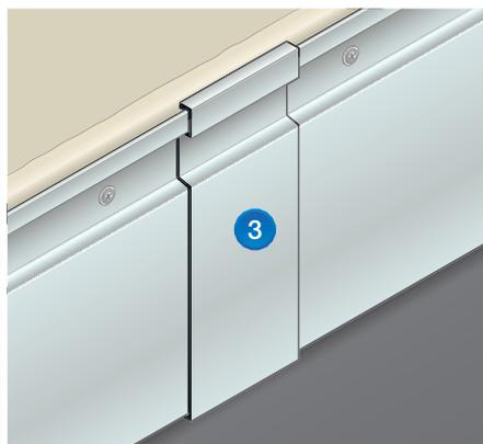
3) **Fourreaux de jonction**, permettent un alignement parfait entre éléments, un recouvrement de jonction efficace, tout en laissant un jeu de dilatation adapté.
