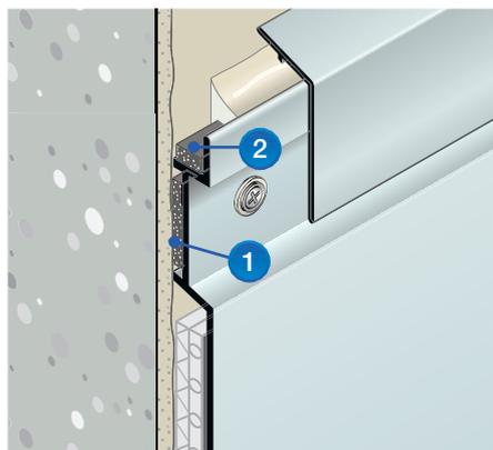
1) **Joint à l'arrière**, permet de rattraper les irrégularités et fait barrière entre l'étanchéité et le joint pompe.
